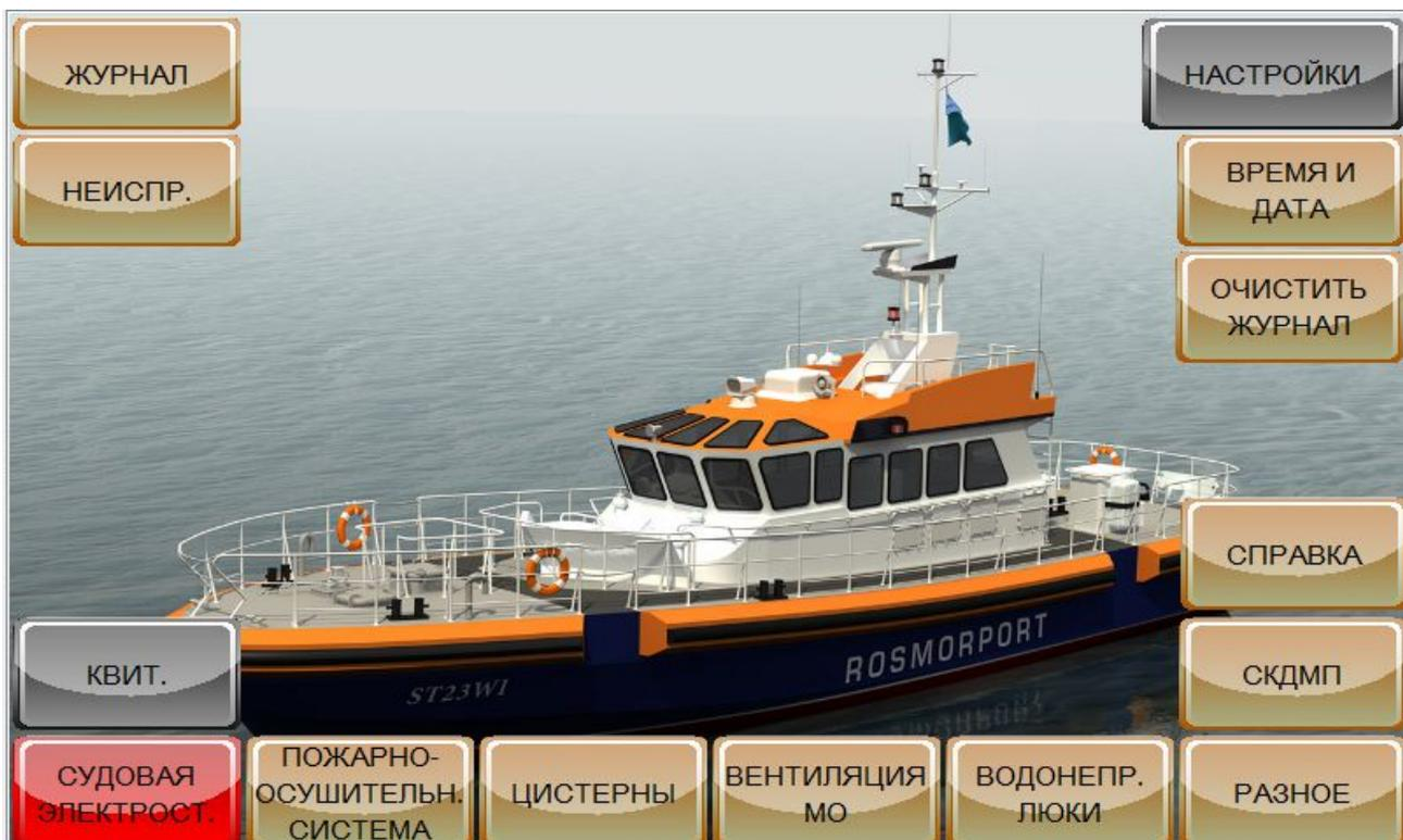
Рисунок 3.1 — Внешний вид главного экрана.
