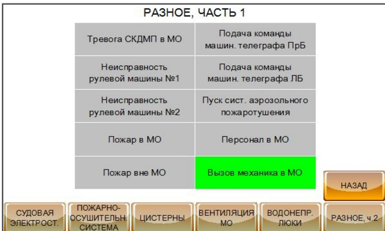
Рисунок 3.10 — внешний вид экрана «Вызов механика в МО»
