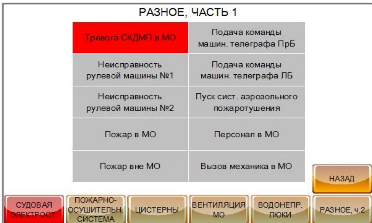
Рисунок 3.9.1 — внешний вид экрана «Тревога СКДМП в МО»
