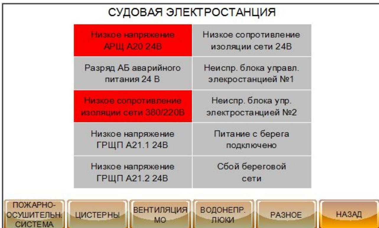
Рисунок 3.3 — Внешний вид экрана «Электроэнергетическая система»
