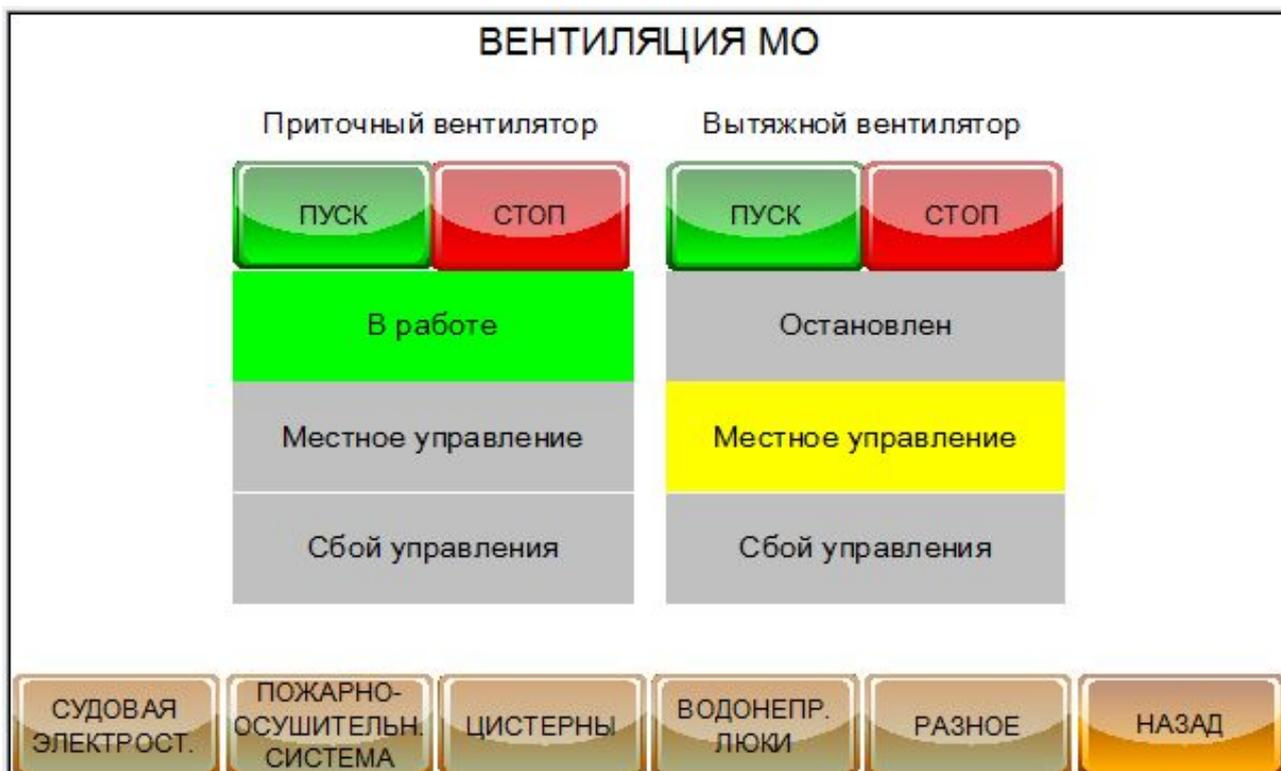
Рисунок 3.6 — Внешний вид экрана «Вентиляция МО»
