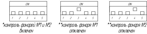
Варианты выставление DIP перкл. на силовом блоке БС КМ контроль питания:
